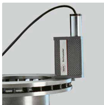
简单的小型零件高空测量
